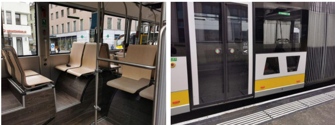
Abbildung 20: Beispiele für besondere Fahrzeugausstattung (linkes Bild: Fußboden und Sitze in Holzoptik; rechtes Bild: zusätzliche Fenster im Fußraum und transparente Faltenbälge; Schaffhausen)
